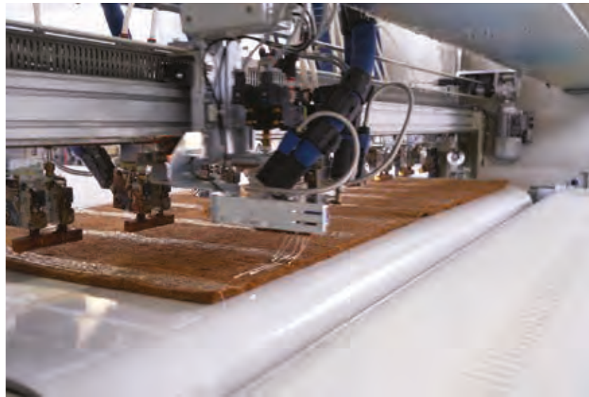
Αυτόματη συγκόλληση των υλικών με ποιοτική κόλλα φιλική προς τον άνθρωπο. Automatic welding of materials with quality, human-friendly glue.
