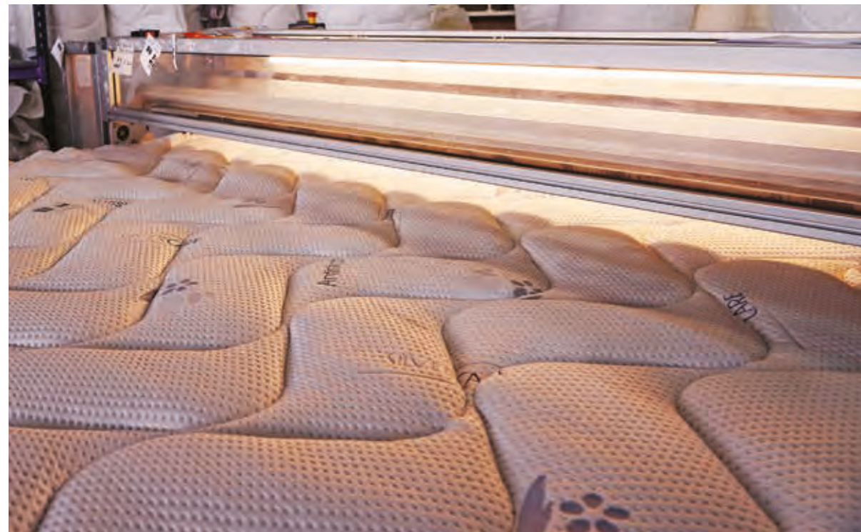
Η μηχανή αυτόματης κοπής χρησιμοποιείται για την ακριβή κοπή των υφασμάτων καπιονέ. The automatic cutting machine is used for precise cutting of quilted fabrics.
